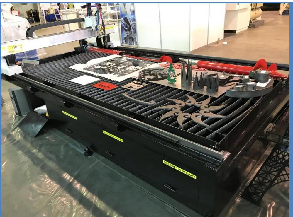
Стол обшият со всех сторон. Имеются специальные люки для очистки от шлака, система многозонной вытяжки, которая многократно повышает производительность вытяжного вентилятора, т.к. тяга идет только в зоне реза. При обустройстве системы вентиляции необходимо приобретать вытяжной вентилятор, сделав предварительный расчет.
