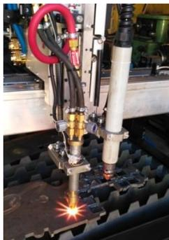
Газовый резак Harris (США) Электронный блок управления, электроклапана подачи газокислородной смеси, редукторы регулировки давления газа в системе. Максимальная толщина резки от 4мм до 100мм.
