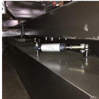
открывают воздушные заслонки только там, где работает резак. В остальных зонах заслонки закрыты. Данная конструкция позволяет более продуктивно использовать вытяжную систему.
