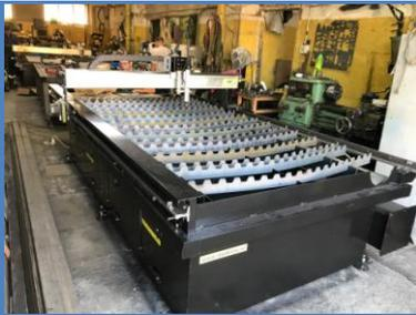
Координатный стол GR-3015H с приводами, управления ЧПУ в навесном ящике. Без вытяжной системы.
