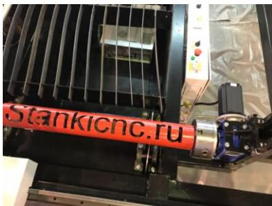
Четвертая дополнительная ось (ось А) для резки круглых труб. Позволяет фигурно, по программе резать трубы диаметром 50-250 мм. Возможность применения: винтовые сваи, фигурные элементы конструкции, элементы соединения трубопроводов и т.д.
