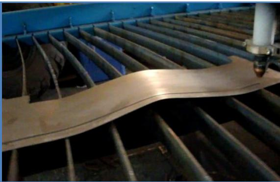
**Принцип работы контроля высоты основан на измерении напряжения дуги плазматрона при его работе. В связи с этим нет необходимости в установке на резаке дополнительных неудобных тарелок и внешних навесок.**
