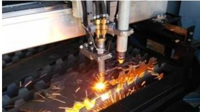
Данную модель возможно дооснастить дополнительным газо-кислородным оборудованием, включающим газовый резак,
